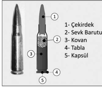
Resim 1: 7.62x39 mm Kalashnikov fişegi ve kesiti
