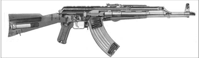
Resim 3: Kalashnikov (AK-47) piyade tüfeğinin mekanizması ve parçaları.
