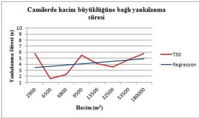
Şekil 8: Cami yapılarında hacim büyüklüğüne bağlı çınlama süreleri (Eröz, 2014: 6)
